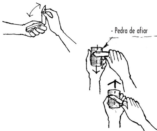
Seu uso é similar ao da faca, cortando sempre para fora do corpo. Conserve-o longe da terra, da umidade e do fogo, mantendo-o limpo, seco e afiado, para o qual podes usar uma pedra de afiar, realizando o mesmo processo da faca. Finalmente, para guardá-lo, coloque óleo nas lâminas e molas.
